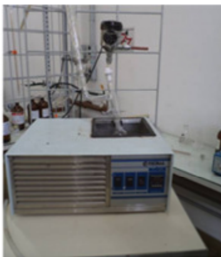
Figura 6. Reator com aquecimento elétrico para preparo de AAS
