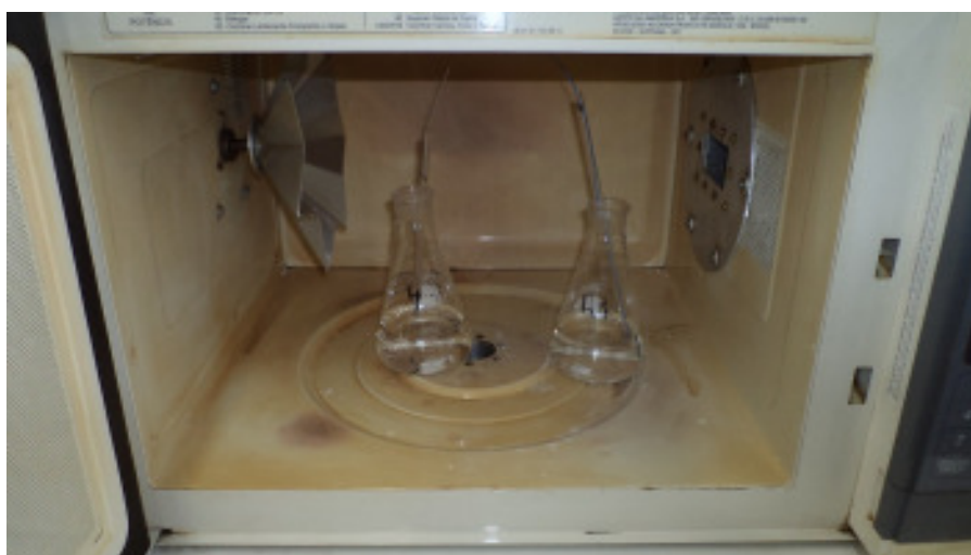
Figura 12. Pré-aquecimento dos reagentes com micro-ondas.
