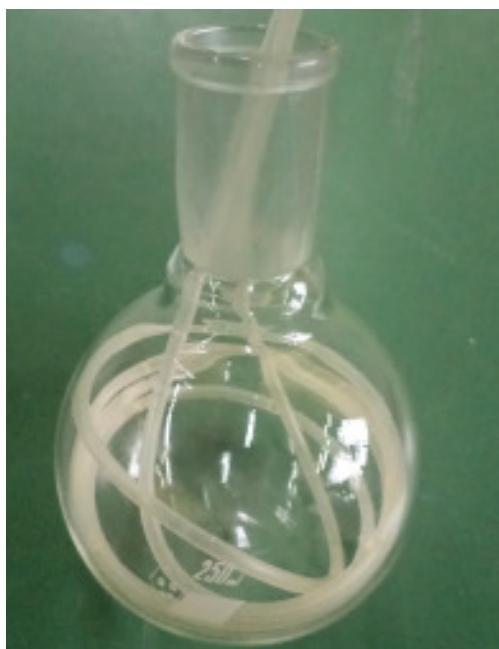
Figura 16. Sistema de refrigeração do reator.
