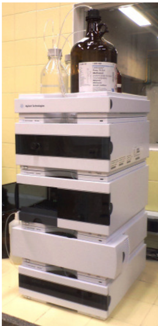
Figura 5. Foto do instrumento para análise HPLC da Agilent Technologies 1260 Infinity
