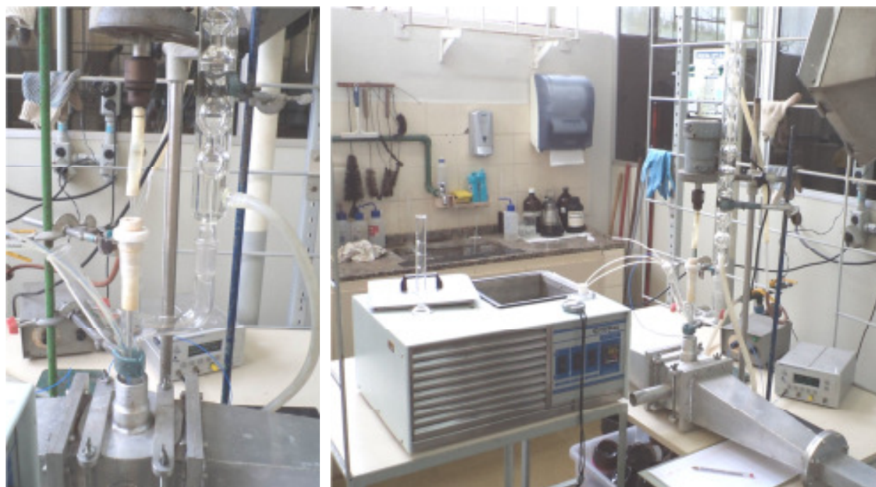
Figura 26 (a) e (b). Detalhes da versão final do reator para AAS
