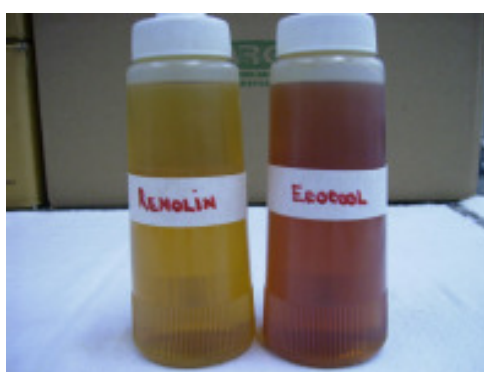
Figura 3.5 – Fotografia dos óleos utilizados: Ecocool (óleo solúvel) e Renolin (óleo hidráulico)
