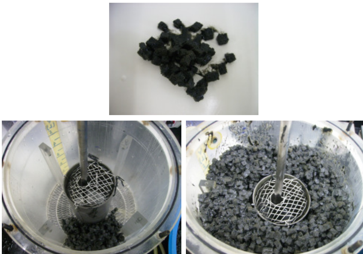
Figura 3.7 – Fotografias do procedimento de imobilização da biomassa em espuma de poliuretano e preenchimento do reator
