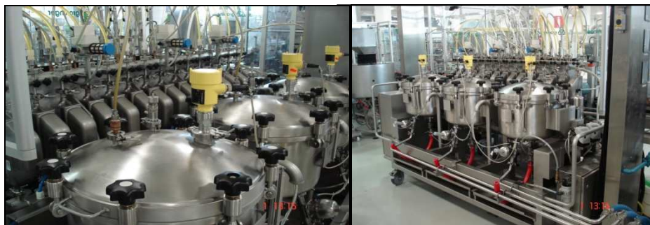
Figura 9 - Linha de envase automática Groninger (FONTE: Base de Dados Natura-CIB.Engenharia, 2007)
