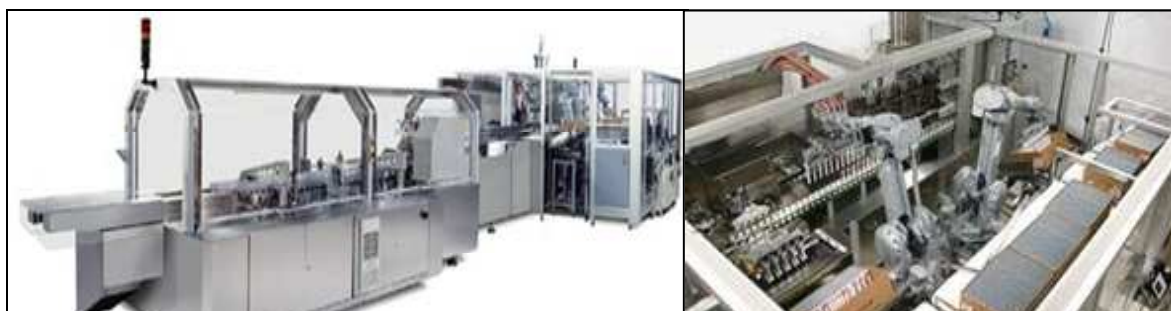
Figura 21 - Envasadora de bisnagas de alta velocidade e robô para alimentação - velocidade 500 unid/min (FONTE: www.nordenmachinery.se )
