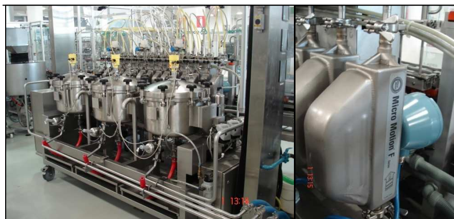
Figura 11 - Linha de envase automática com controlador mássico (FONTE: Base de Dados Natura-CIB.Engenharia, 2007)
