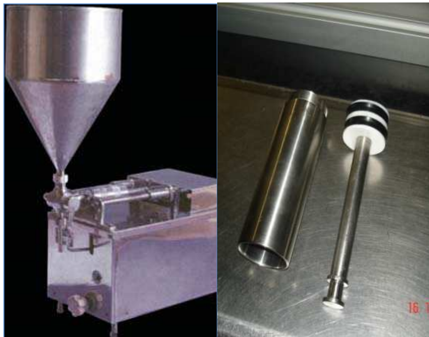
Figura 6 - Máquina de envase manual e detalhe da bomba tipo "pistão" (FONTE: WWW.tecosmaq.com.br)
