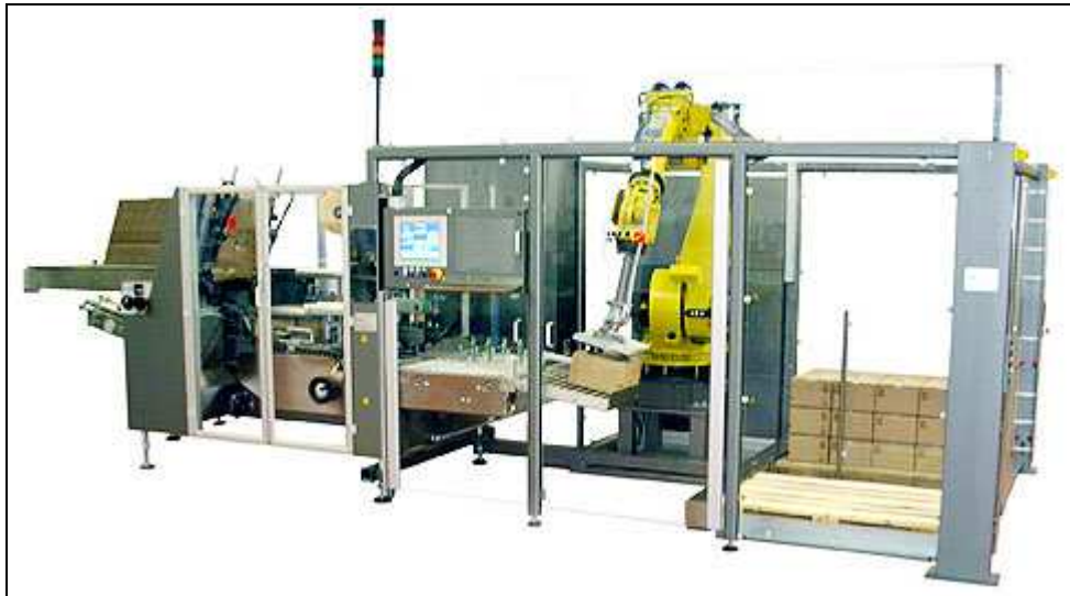
Figura 23 - Encaixotadeira e Paletizadora para 10 caixas por minuto (FONTE: www.ima.it )
