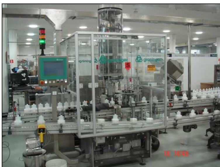
Figura 10 - Linha de envase de desodorantes - Fabricante Groninger (FONTE: Base de Dados Natura-CIB.Engenharia, 2007)
