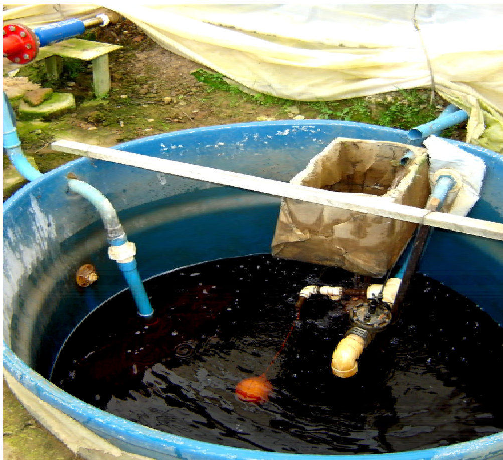
Figura 51: Montagem do reservatório (secundário) de solução da célula condicionada
