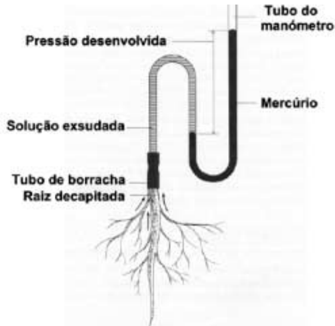
Figura 17: Experiência que mostra a existência de pressão radicular. A solução excretada pela base do caule está sujeita a uma pressão que pode ser lida no manômetro de mercúrio. (Galston, Davies e Satter, 1980)
