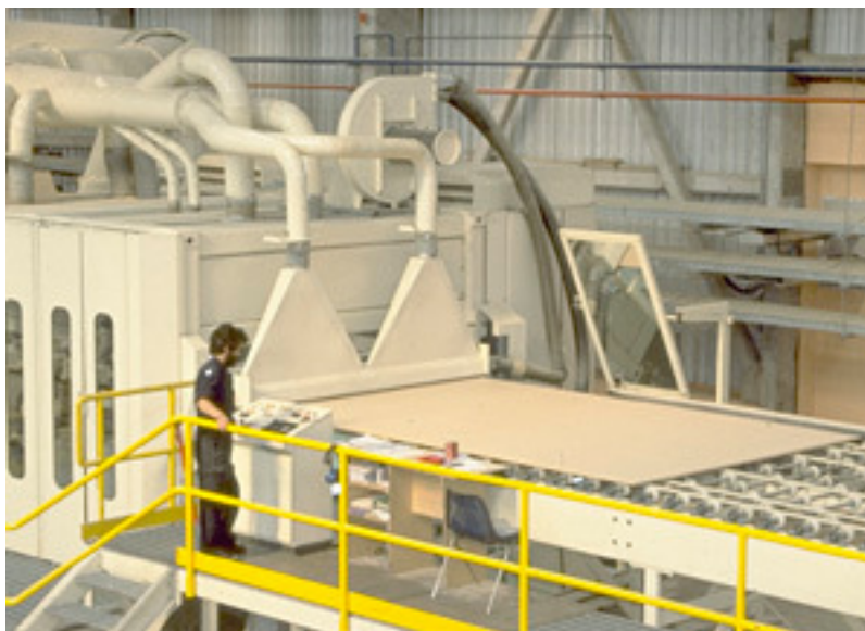
Figura 7.17 – Lixamento das chapas de MDF (Metso, 2005)
