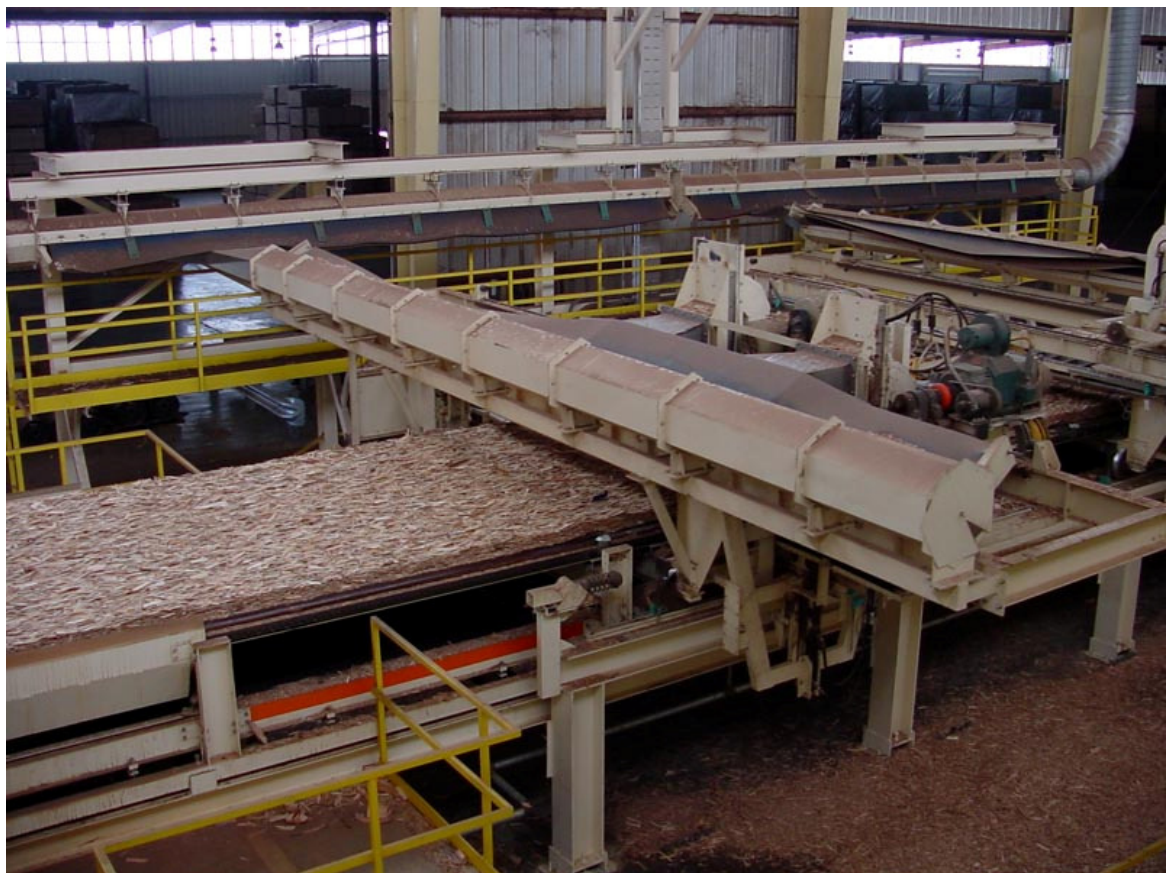
Figura 3.11 – Entrada do colchão de partículas na prensa (PLT, 2001).
