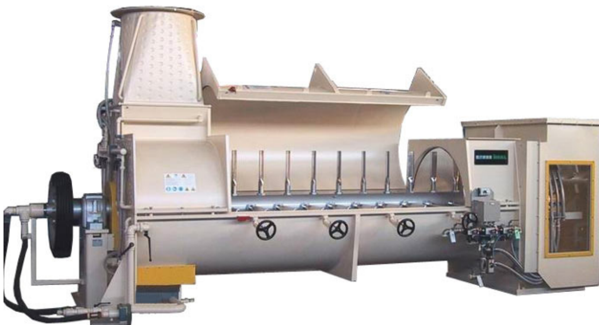
Figura 3.6 – Misturador de sólidos para aplicação de resina e parafina (Binós Technologies, 2005).
