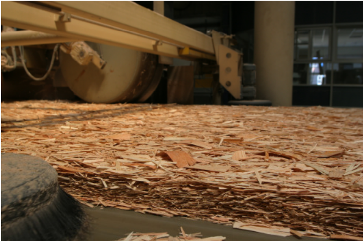
Figura 3.10 – Detalhe do colchão de partículas, que seguirá para prensagem. (Kabel, 2005)
