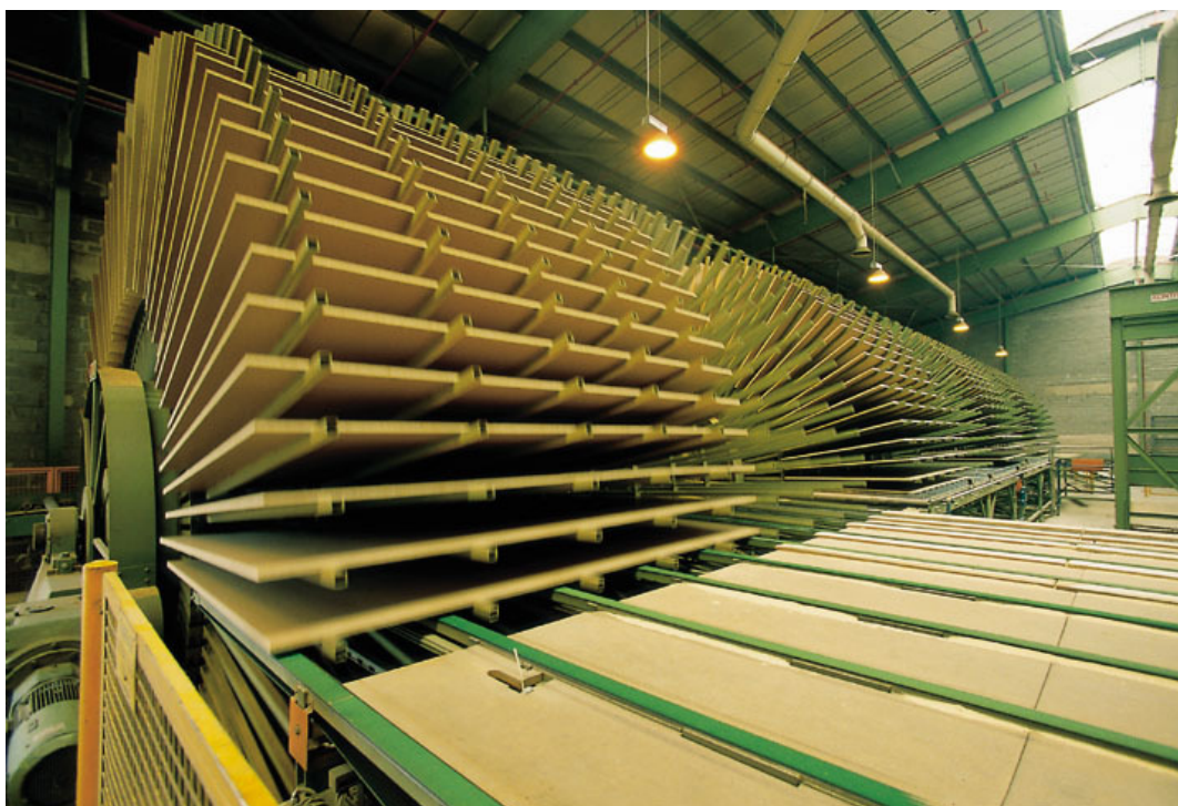
Figura 7.16 – Detalhe da saída das chapas do resfriador (Tafisa, 2005).
