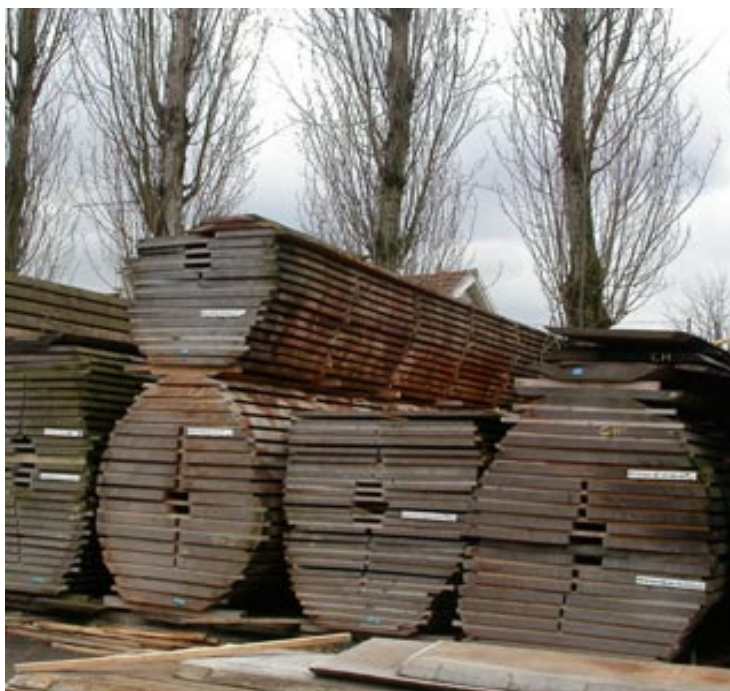
Figura 2.11 – Secagem de madeira ao ar livre (Prat, 2005).
