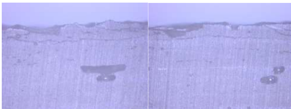
Figura 5 – Delaminação do Corpo de Prova 19 – Vista de Topo
