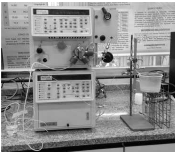
Figura 4- Percolação feita através da coluna de aço inox com o auxílio de bomba HPLC
