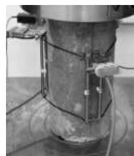
Figura 3: Ensaio de compressão. Figura 4: Ensaio de tração por compressão diametral. Figura 5: Ensaio de Módulo de Elasticidade.
