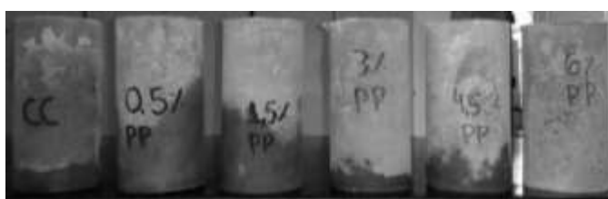
Figura 2: Corpos de prova com variação nas dosagens de fibra de polipropileno.
