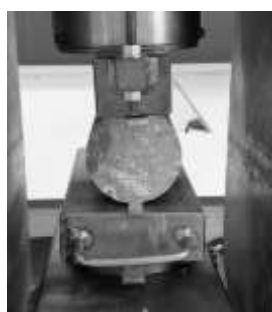
Figura 3: Ensaio de compressão. Figura 4: Ensaio de tração por compressão diametral. Figura 5: Ensaio de Módulo de Elasticidade.
