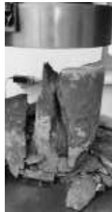
Figura 7: Corpo de prova após o ensaio de compressão. Figura 8: Aderência das fibras na matriz.
