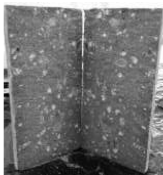
Figura 9: Corpo de prova sem adição de fibras após o ensaio de tração por compressão diametral.
