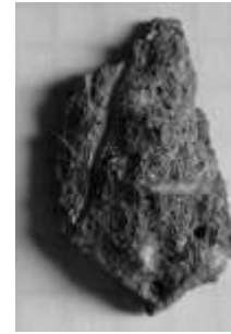
Figura 7: Corpo de prova após o ensaio de compressão. Figura 8: Aderência das fibras na matriz.
