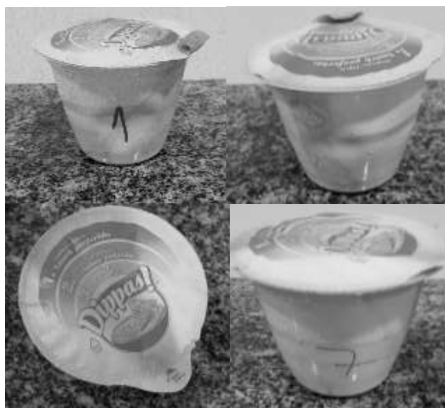
Figura 8: Deformação das embalagens após processo de esterilização.
