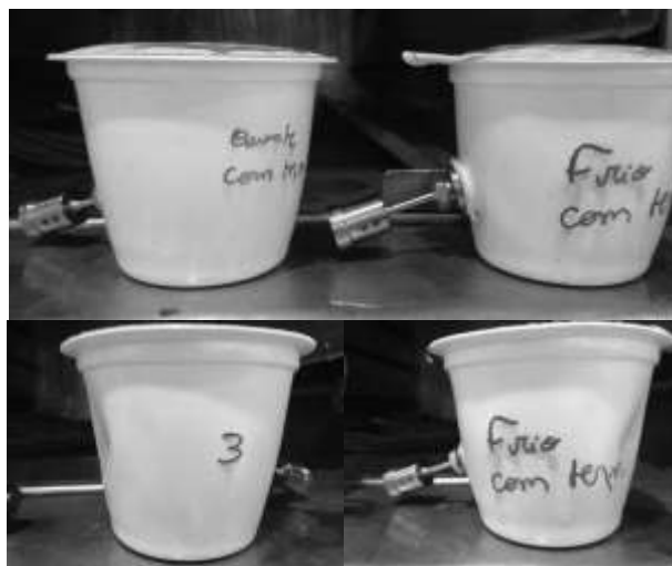
Figura 6: Embalagens após tratamento térmico na autoclave para os ensaios 1 e 2.
