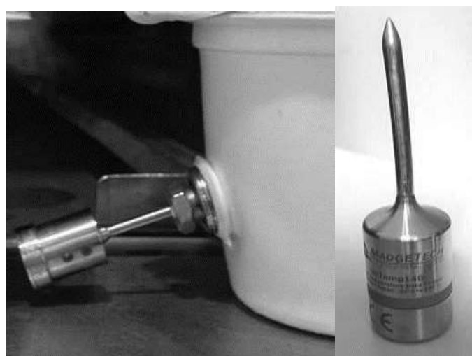
Figura 4: Posicionamento do termopar na embalagem semirrígida para aquisição de temperatura.
