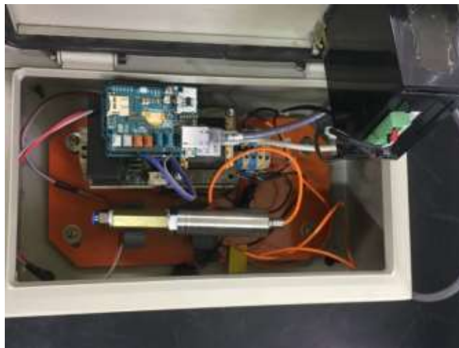
Figura 6 – Acoplamento do sensor de frequência no Arduino.
