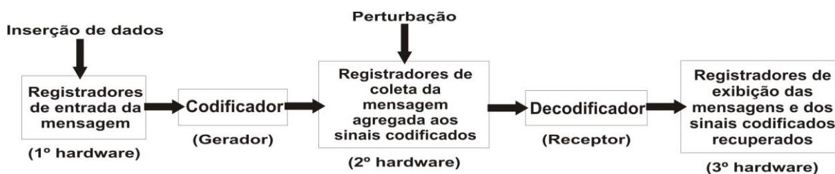
Figura 2 – Diagrama de blocos do “kit” didático para a aprendizagem de técnicas de codificação Reed Solomon.
