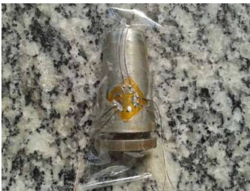
Figura 3. Corpo de prova após a preparação, e pronto para medição.
