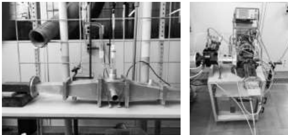
Figura 2 - Sistema utilizado para realização da reação de DOP incentivado por Micro-ondas de 2,45GHz
