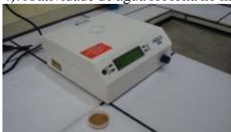
Figura 4 - Analisador de atividade de água - Decagon
