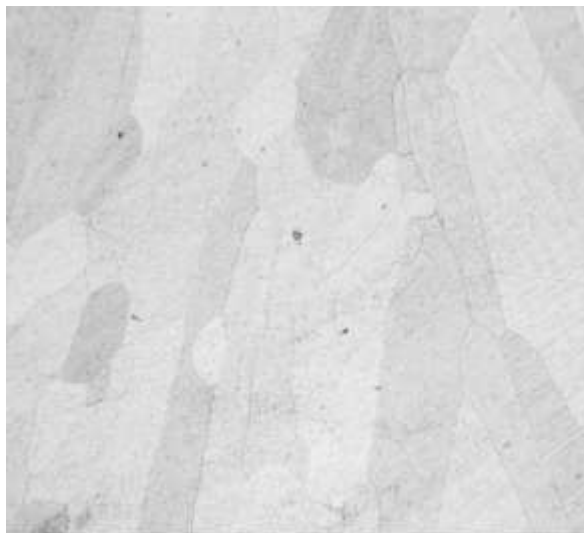
Figura 8 – Micrografia da região da solda. Solda automática. Ataque Vilela - aumento 100x
